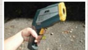
▲体表面の温度測定に使っている放射温度計
